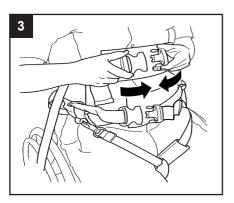
Fare scorrere verso l'alto e posizionare l'imbracatura Standing Harness sul torace dell'utente. L'imbracatura Standing Harness è dotata di due fibbie di sicurezza regolabili. Agganciare entrambe le fibbie di sicurezza come indicato in figura e regolarne la tensione per assicurare all'utente il comfort adeguato (devono essere aderenti, ma non troppo strette).
