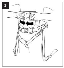
Fare scorrere verso l'alto e posizionare l'imbracatura Standing Harness sul torace dell'utente. L'imbracatura Standing Harness è dotata di due fibbie di sicurezza regolabili. Agganciare entrambe le fibbie di sicurezza come indicato in figura e regolarne la tensione per assicurare all'utente il comfort adeguato (devono essere aderenti, ma non troppo strette).
