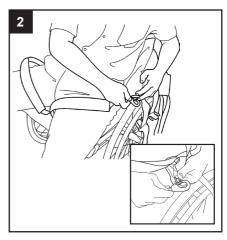
Agganciare i sostegni per le gambe dell'imbracatura Standing Harness fissando il moschettone di sicurezza all'anello di ritenzione alla base dell'imbracatura Standing Harness come mostrato in figura. I sostegni per le gambe, regolabili in lunghezza, assicurano il necessario comfort dell'utente.
